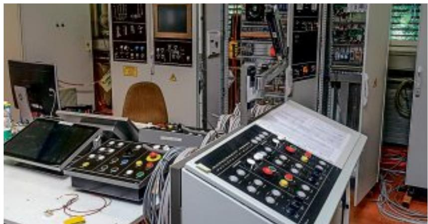
Die brandneue Connect-Steuerung der 10er-Gondelbahn Fiesch-Kühboden in Wallis steht im Testraum der Frey AG Stans bereit zur Werkprüfung.
