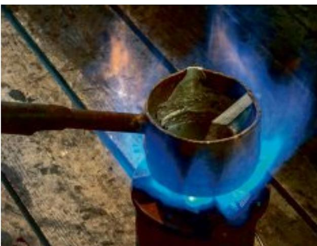
Das Vergussmaterial ist eine Zinklegierung und wird über 300 °C erhitzt.
