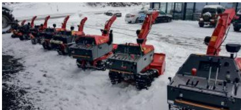
Das Produktspektrum von YANASE reicht von 10 bis 44 PS. Noch eindrücklicher sind die Leistungsdaten: Sie gehen von 50 Tonnen bis zu 240 Tonnen bewegtem Schnee pro Stunde.
