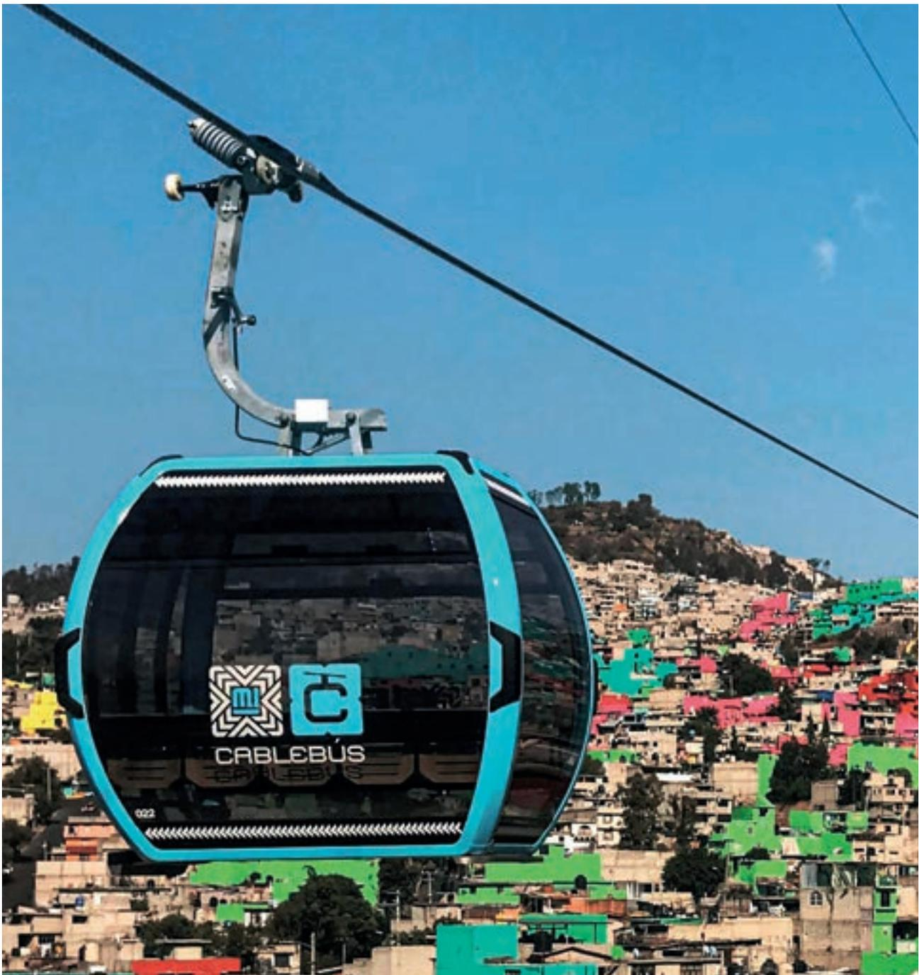
Der heimliche Titelbildstar: In der kleinen weißen Box am Kabinendach bei der neuen Stadtseilbahn in Mexico City wird die gesamte Datenkommunikation zwischen den Kabinen und den Stationen abgewickelt.
