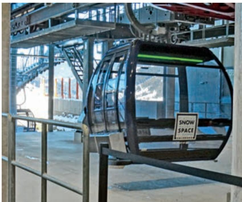
Loop21 hat eine spezielle Sitzplatzerkennung entwickelt – und diese zeigt via farbige LEDs den Befüllungsgrad der Kabine an.
