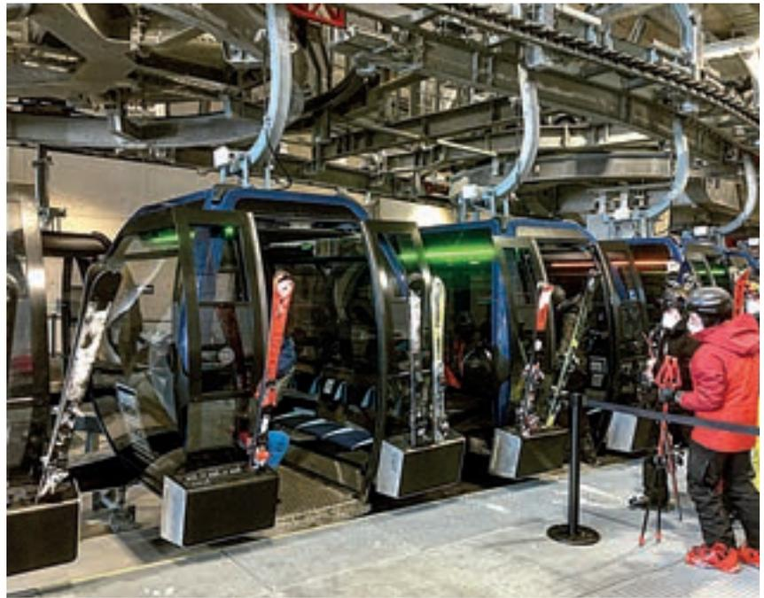
Eine der besonderen Technikinnovationen, entwickelt von Loop21 und bei der Flying Mozart zum ersten Mal eingesetzt (siehe auch S. 18 f.): Eine Sitzplatzerkennung zeigt den Füllgrad der Kabine in der Mittelstation mittels farbiger LEDs an. Vier Kabinen im Langsammodus ermöglichen ein völlig stress- und drängelfreies Einsteigen.
