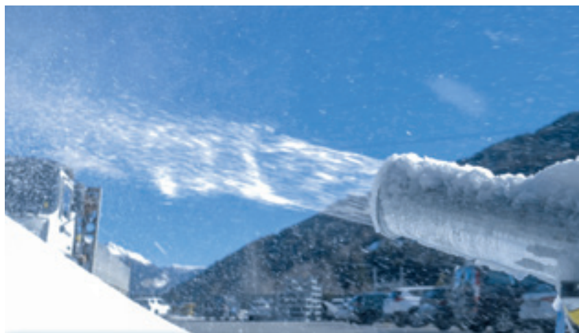
Schneeproduktion bei Plustemperaturen, die Königsdisziplin in der technischen Schnee-Erzeugung.
