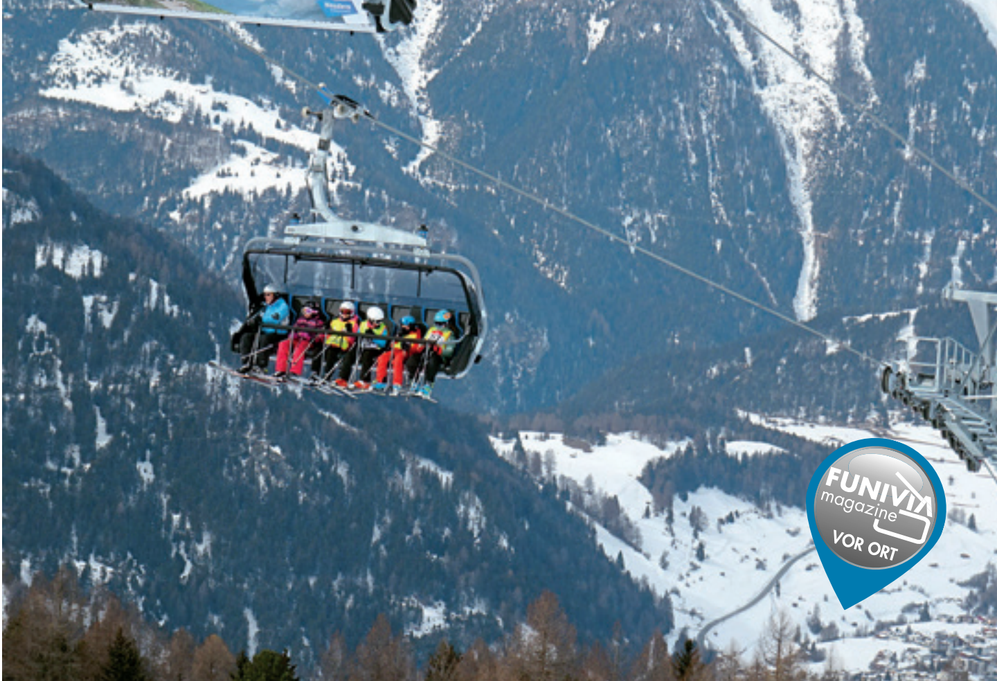
Sicherer Familienkomfort: gepolsterte Einzelplätze mit Nackenstütze und Sitzheizung – dazu eine eigene Kindersicherung.
